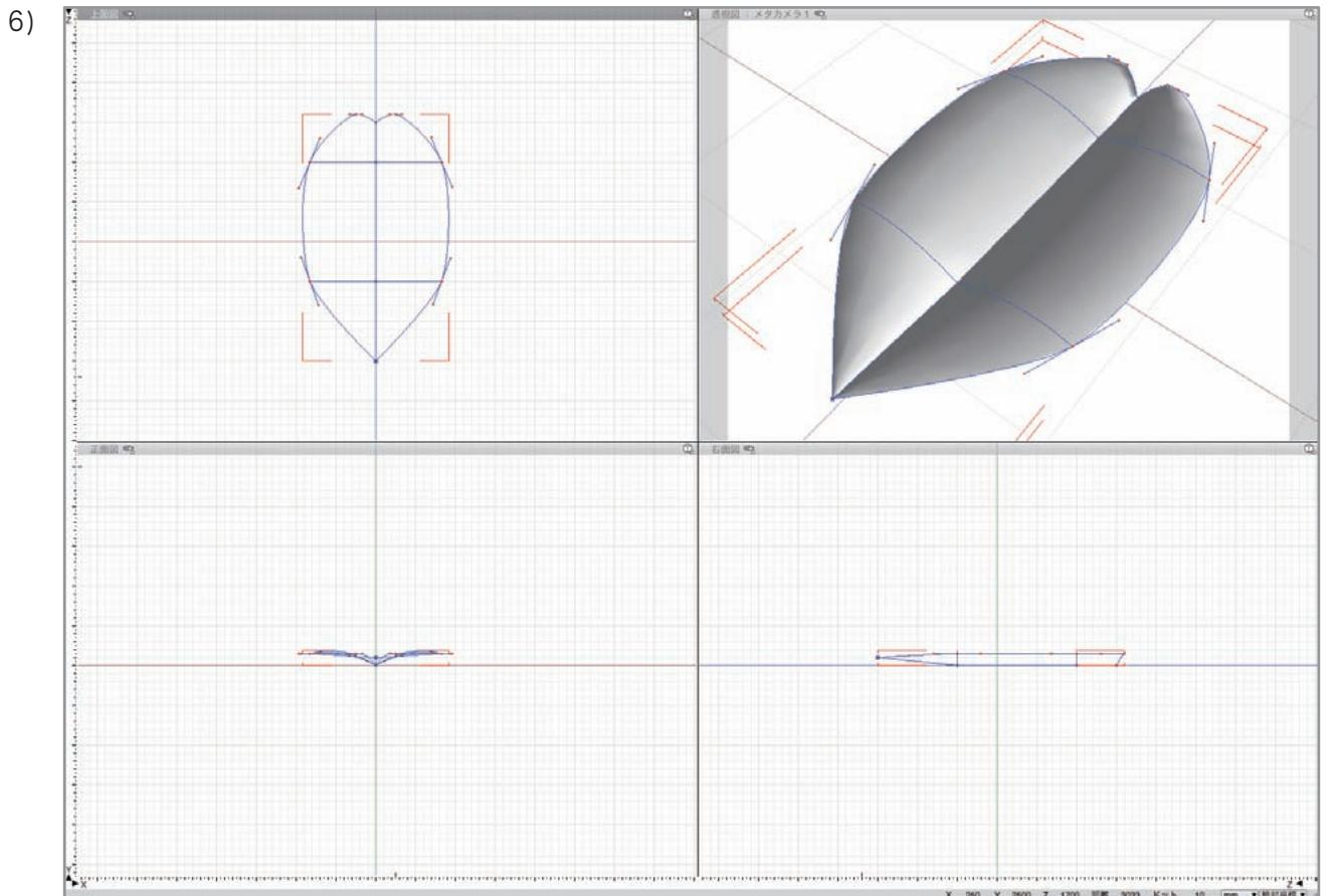
ここまでに作成したコントロールポイントにハンドルを追加して、曲面を作り上げる。葉っぱの先端となる部分はコントロールポイントを一点に収束を行う。側面図で、コントロールポイントを移動させることによって、葉っぱのしなりを作ることによって、葉っぱのしなりを作る。
